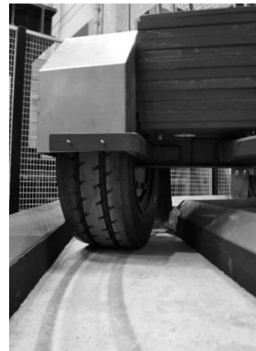
Abbildung 6: links: Versuchsstand zum gleichzeitigen Einwalken einer Prüflösung in 6 großformatige Probekörper (180 x 50 x 27 cm³); rechts: überrollendes Rad
