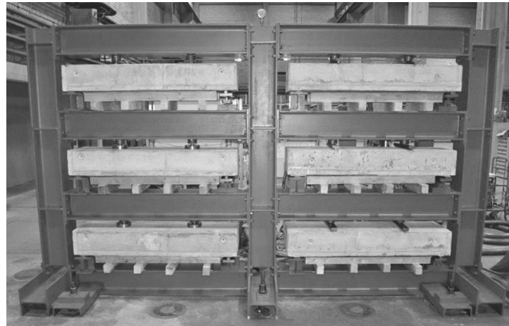
Abbildung 1: Versuchsstand zum zyklischen Belasten für 6 großformatige Probekörper (180 x 50 x 27 cm 3 )
