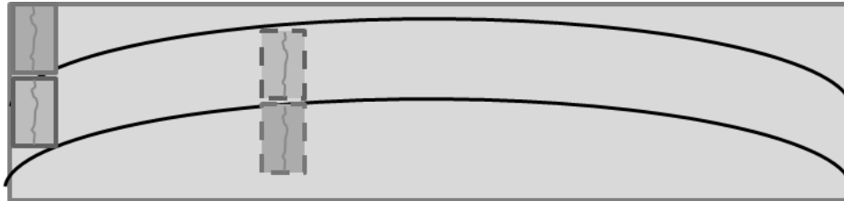
Abbildung 7: Balkenaufsicht mit Reifenspur und Entnahmestellen der Teilproben
